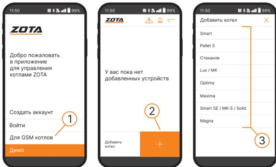
Рис.6 Приложение ZOTA Net - подключение GSM котлов
