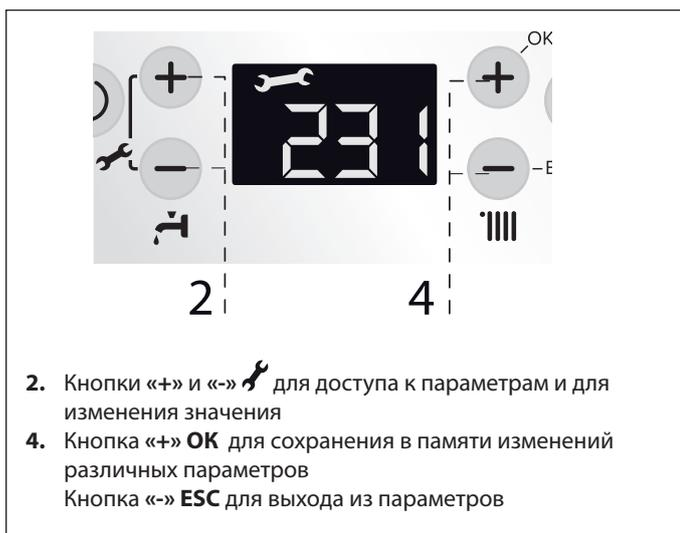
Информация, относящаяся к выбранному параметру отображается на дисплее с помощью цифр.
