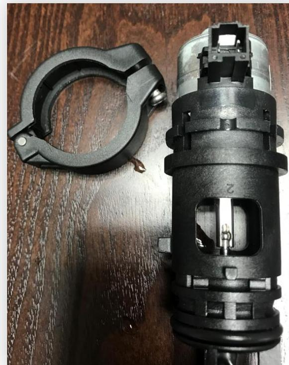
**Автоматическое изменение положения ГВС - ОТОПЛЕНИЕ**
