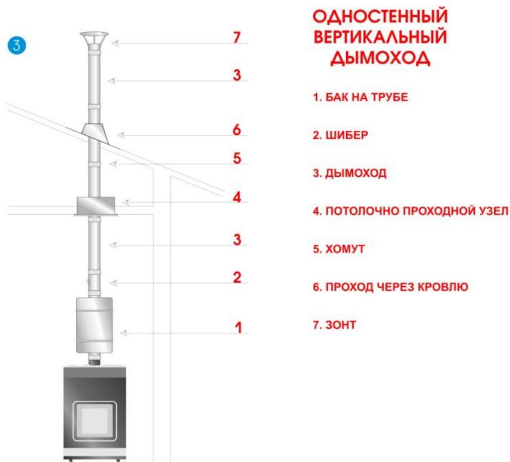
Рис.4 Типовые схемы сборки системы дымоходов.
